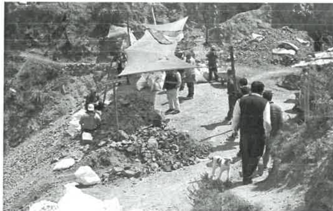
Fotografía N° 03 Cancha de mineral contigua a la boca mina, se evidencia trabajo de pallaqueo de personal sin equipos de protección personal.
