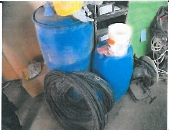
Almacenamiento inadecuado de combustible
