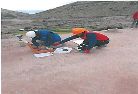
24: Se observa que los equipos con los que se viene realizando los ensayos de campos no tiene certificado de calibración que se pudo corroborar insitu.
